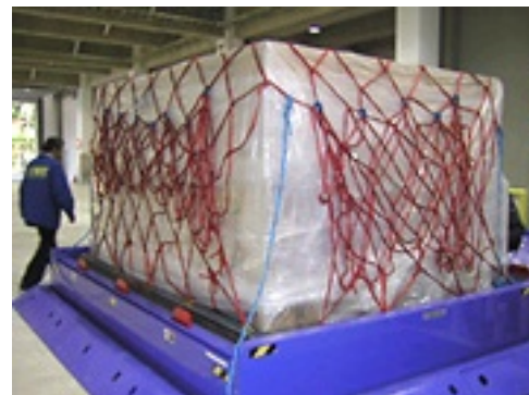
パレット・ステーションの沈下式床
