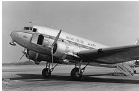
DC3：1935年初飛行、1万機以上生産され1960年代まで世界中で使われた。輸送機型は4トンの貨物を搭載 リンク：DC3写真
