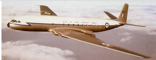
デハビラント コメット 金属疲労による空中分解事故が連続して起こり、飛行停止になった
